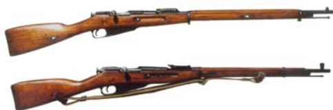
圖 59 上:莫辛那干 1891、下:莫辛那干 91/30,其照門與槍托固定方式均不相同。
